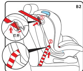
步骤二：拉出汽车安全带，按照图B2,B3中①②③路径的穿带方式固定座椅。
