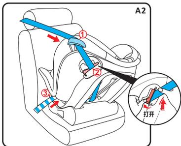
步骤二：拉出汽车安全带，按照图A2,A3中①②③④路径的穿带方式固定座椅
