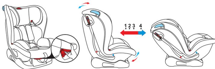
安全座椅有4个倾斜角度可调。如果是后向安装（0+, I组），只能使用第4档。如果是前向安装（I组），则使用1~3档如果是前向安装（II, III组），则使用1档。使用方法：向上抬起座椅前部下方的角度调节把手，然后向前拉或者向后推。到达想要的档位后放开角度调节把手，最后推动座椅直到听见“喀哒”声。
