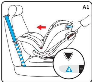
步骤一：将儿童安全座椅角度调整到第4档，并后向安放到汽车后排座椅上，确保安全座椅前端紧靠汽车座椅(A1)。
