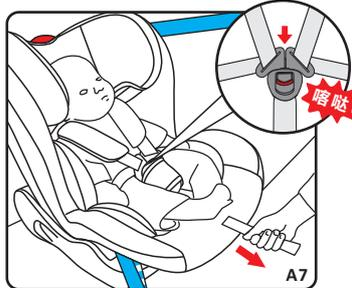
步骤六：将孩子抱入安全座椅中，用五点式安全带固定，拉动调节带使肩带紧贴孩子肩部(A7)
