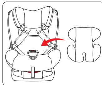
打开五点式安全带，将怀抱型棉垫放入儿童安全座椅内，调整好胯垫和肩带，用五点式安全带固定即可
