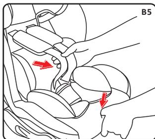
步骤四：按压座椅前端的织带调节按钮，配合另一只手将肩带向前拉动，使安全带处于宽松状态(B5)。
