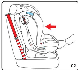
步骤二：将安全座椅前向放置到汽车后排座椅上，确保安全座椅紧靠汽车座椅(C2)。
