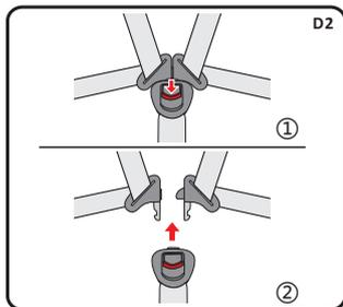
步骤二：打开五点式安全带系统(D2)。
