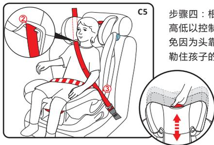
步骤四：根据孩子身高调节头靠高低以控制安全带的路径高低，避免因头靠太高或太低而使安全带勒住孩子的脖子 (C5,C6)。
