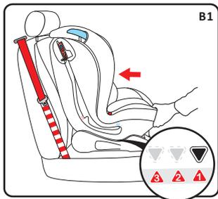
步骤一：将儿童安全座椅角度调整到第1~3档宝宝舒适的角度，并前向安放到汽车后排座椅上，确保安全座椅紧靠汽车座椅(B1)。
