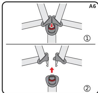
步骤五：打开五点式安全带系统(A6)。
