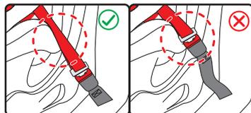
**▲ 注意：**汽车安全带锁扣带过长，不适合用于绑定汽车安全座椅，否则发生碰撞时，起不到保护作用。使用前，请检查汽车安全带是否适用。
