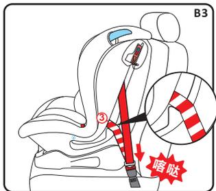
步骤三：按照箭头方向收紧汽车安全带，确保安全座椅被牢固绑定(B4)
