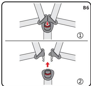
步骤五：打开五点式安全带系统(B6)。
