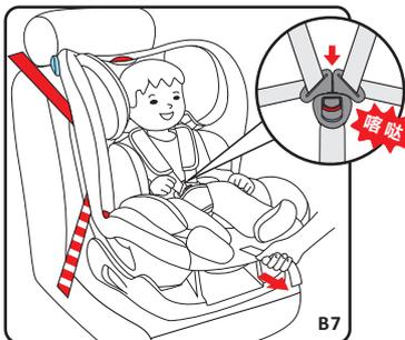
步骤六：将孩子抱入安全座椅中，用五点式安全带固定，拉动调节带使肩带紧贴孩子肩部(B7)
