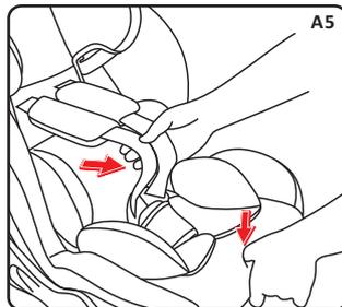
步骤四：按压座椅前端的织带调节按钮，配合另一只手将肩带向前拉动，使安全带处于宽松状态(A5)。
