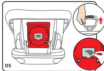
步骤五：将日型扣转至最扁，配合另一只手将胯垫及锁扣取出(D5)。
