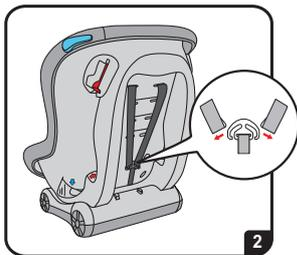
**步骤二：**安全座椅转至背面，将两根肩带从织带连接片中退出
