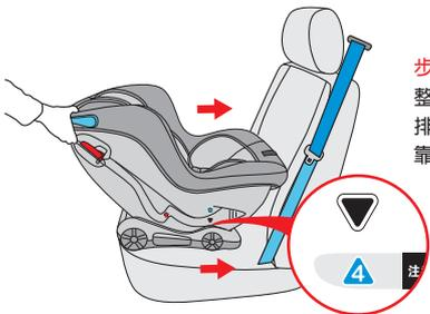
**步骤一：**将儿童安全座椅角度调整到第4档，并后向安放到汽车后排座椅上，确保安全座椅前端紧靠汽车座椅。
