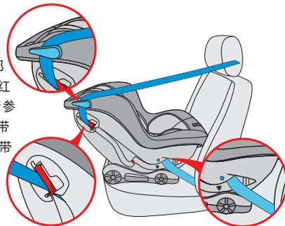
**步骤五：**在安全座椅另一侧，汽车安全带-腰带部分以同样的方式卡入“0+组安全带过带槽”。
