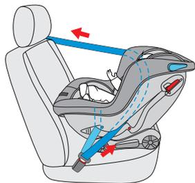
**步骤六：**按照红箭头方向，向上提拉收紧汽车安全带，使安全带处于紧绷状态，最后将孩子放入安全座椅，用五点式安全带固定好孩子即可。确保安全带没有打结或扭曲。
