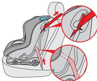
**步骤三：**将安全带-肩带部分如图卡入同侧红色锁止夹中(锁止夹的使用方法请参阅说明书第9页)。再将安全带-腰带部分卡入安全座椅“I组安全带过带槽”。
