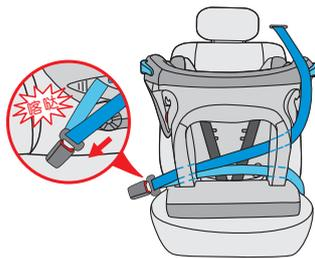
**步骤三：**安全带穿过座椅后背两侧过带孔，再将安全带插片插入汽车插扣座内锁定，直到听见“喀哒”声。
