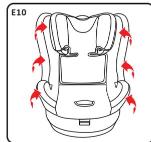
步骤九: 将布套按箭头方向卸除布套即可(E10)
