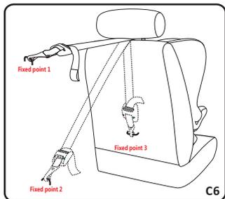
步骤六：将上拉带与汽车所配备的固定点固定(C6)。
