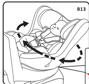
步骤十三：将座椅旋转至反向，当听到“喀哒”声，开关滑向“锁定”状态即可 (B13,B14)
