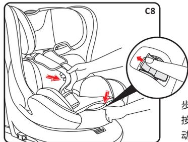
步骤八：按压座椅前端的织带调节按钮，配合另一只手将肩带向前拉动，使安全带处于宽松状态(C8)。
