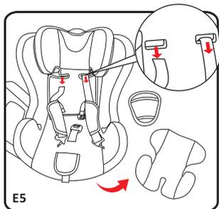
步骤五: 将肩带从座椅正向拉出, 卸除棉垫, 肩套, 胯垫(E5,E6).
