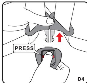
步骤二：打开五点式安全带系统(D4)。
