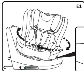
步骤一：用拇指外拉底座下的旋转拉手后，配合另一只手旋转安全座椅至侧向(E1)。
