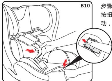
步骤十：按压座椅前端的织带调节按钮，配合另一只手将肩带向前拉动，使安全带处于宽松状态(B10)。
