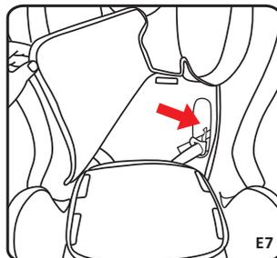
步骤六: 拉开座椅靠背布套, 将肩带移入布套内, 隐藏在座椅塑料件两侧的槽洞中(E7)。
