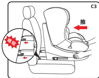
步骤三：将两个安装导向件对准钢性固
