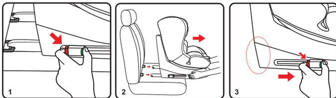
按压两侧解锁开关，解锁座椅两侧ISOFIX接口，将安全座椅移除。
