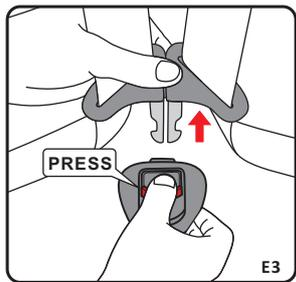
步骤三：打开五点式安全带系统(E3)。
