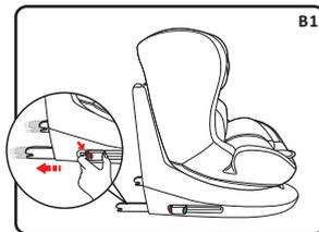
步骤一：按住并滑动ISOFIX解锁开关的同时，使隐藏于底座的ISOFIX接口完全推出(B1)。
