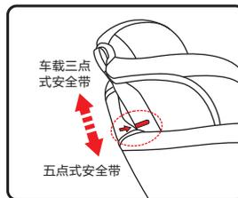
**注意:** 在儿童安全座椅使用过程中, 请随时观察儿童肩高, 头靠随儿童肩高而调整, 当头靠向上调整高度达到或超越界线点时, 需去除五点式安全带系统, 使用II, III组安装方式, 用汽车三点式安全带绑定儿童。
