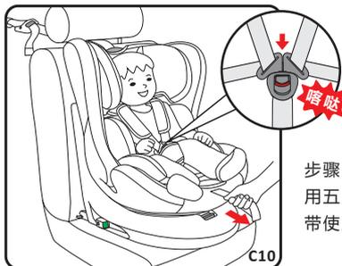
步骤十：将孩子抱入安全座椅中，用五点式安全带固定，拉动调节带使肩带紧贴孩子肩部(C10)
