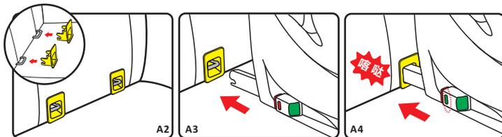
步骤一：找到车辆座位上的ISOFIX两个钢性固定点（C2）。
