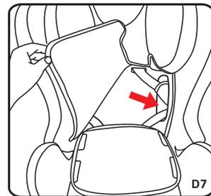
步骤五：拉开座椅靠背布套，将肩带移入布套内，隐藏在座椅塑料件两侧的槽洞中(D7)。
