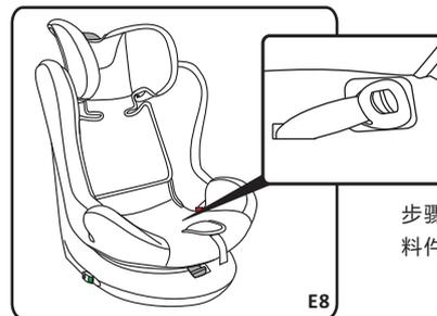
步骤七: 将锁扣收藏在底座塑料件凹槽内即可(E8)。
