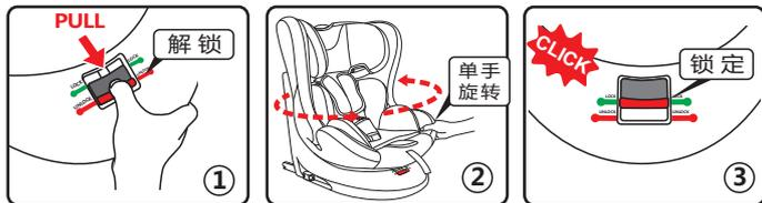
**操作步骤：**①将开关拉至“解锁”状态 ②单手旋转座椅至正向或反向
